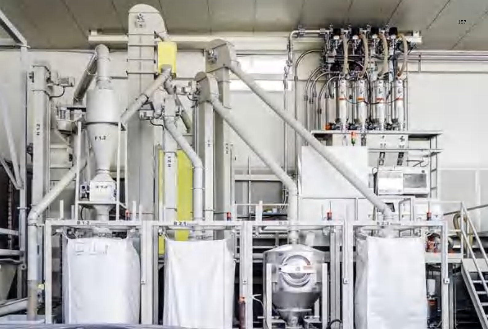
↑ Moderne, l'installation de recyclage permet de réutiliser en interne tous les rebuts de profilés et les chutes de PVC fabriqués par l'entreprise.
