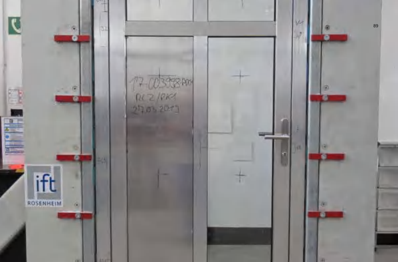
↑ Banc de test sur lequel l'Institut für Fenstertechnik (ift) de Rosenheim (Allemagne) vérifie la résistance à l'effraction des portes d'entrée.
